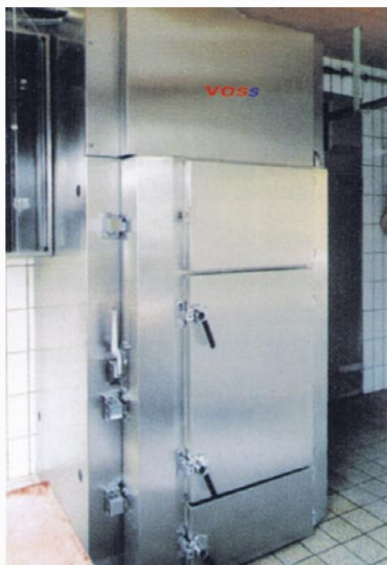
VOSS-Langzeit-Raucherzeuger GIGANT II/ET für das Verschwelen von Hackspänen in automatischer Arbeitsweise
