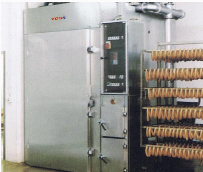
VOSS-Universal-Anlage Typ 2020.2 – Zweiwagen-Anlage – mit Mikroprozessor-Steuerung und Langzeit-Raucherzeuger GIGANT II
