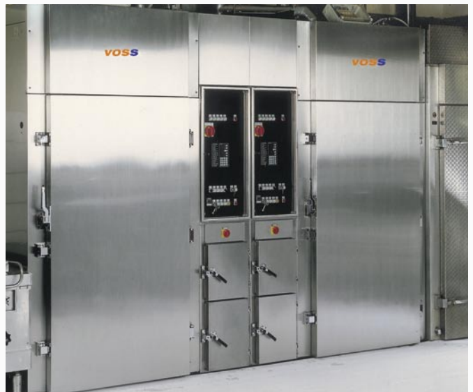
VOSS-Universal-Anlage Typ 1020.2 mit Mikroprozessor-Steuerung und Langzeit-Raucherzeuger GIGANT II
