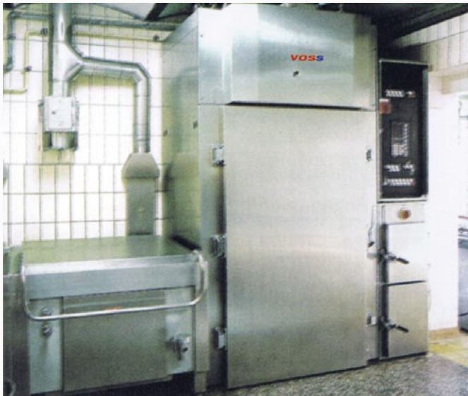
VOSS-Universal-Anlage Typ 917 mit Mikroprozessor-Steuerung und Langzeit-Raucherzeuger GIGANT II
