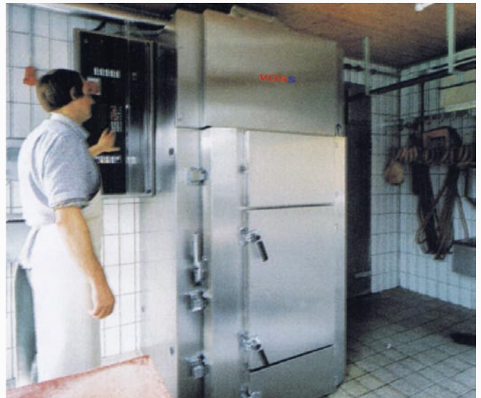
VOSS-Universal-Anlage Typ 815 mit Mikroprozessor-Steuerung und Langzeit-Raucherzeuger GIGANT II/ET
