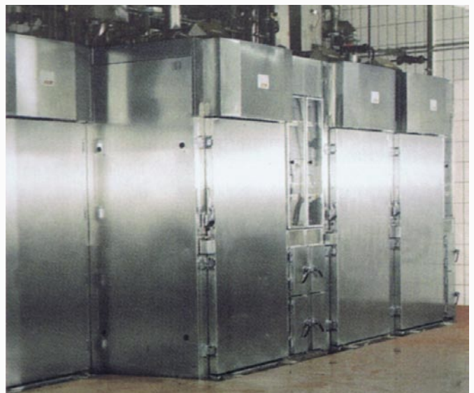
VOSS-Universal-Anlage Typ 1020.2 mit Mikroprozessor-Steuerung und Langzeit-Raucherzeuger GIGANT II
